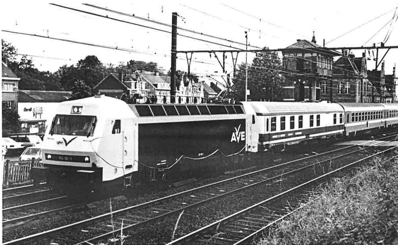
Evaluation de la HL 252-001-3 de la RENFE par la SNCB. La rame est composée de la voiture de mesure et deux voitures I10. la voici en passage à Hall, ligne 94 (photo guy Bridoux - 1 juin 1992)
