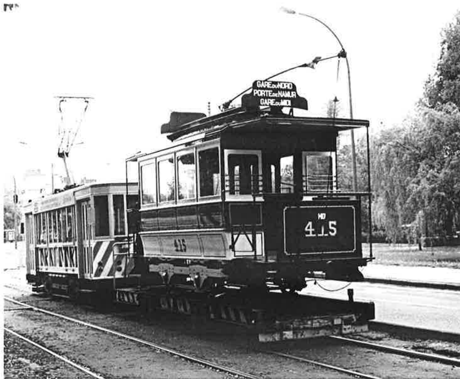
Reconstitution du premier véhicule à traction électrique de 1894. Il s'agit d'un véhicule initialement destiné à la traction chevaline, aujourd'hui non motorisé (photo Guy Bridoux - 8 mai 1994).
